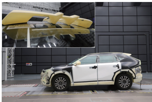
图4 扰流板风噪声验证试验
